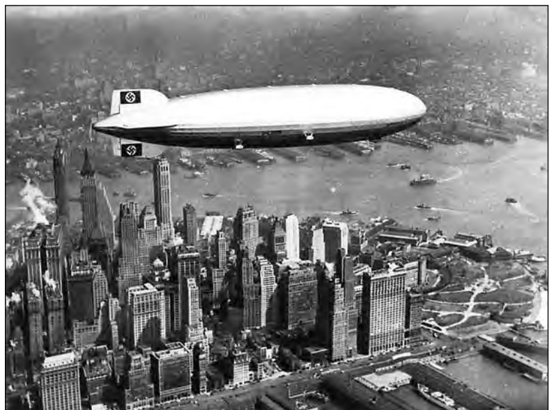
Das Luftschiff „Hindenburg“ hatte eine Länge von 246,7 m. Der größte Durchmesser betrug 41,2 m und das Gewicht etwa 215 t.
